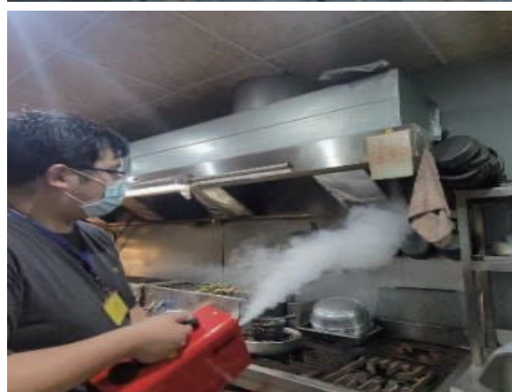
營建工程裸露區域鋪設防塵網抑制揚塵 / 使用科技儀器具象化煙流確認氣罩收集效果
